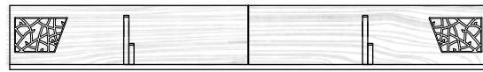
Art. CMP/12 Base 2 cestoni con maniglie legno e traforo cm. L236 P58 H32 Art. CMP/13 Base 2 cestoni con maniglie legno e traforo senza basamento cm. L236 P58 H29,5
